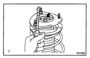
(d) Using 2 nuts and a screwdriver or an equivalent to hold, remove the center nut.
